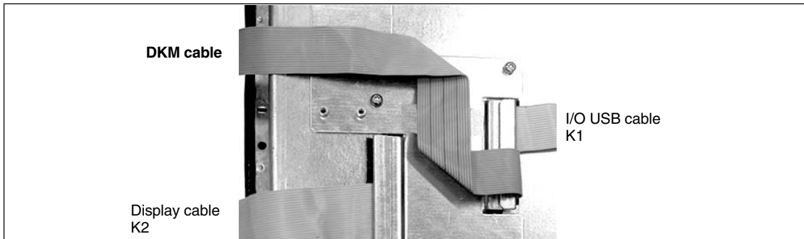
Fig. 11-13 OP 015A: DKM cable routing
